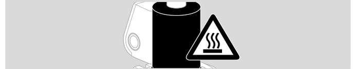
Der Magnetantrieb wird beim Betrieb heiß. Oberflächentemperatur ca. 85 °C (185 °F) nach EN 60730-1.
