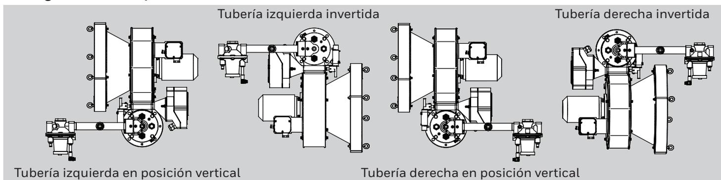
A pesar de que el motor del soplador está en el lado “izquierdo” de las unidades invertidas, sigue siendo un motor “derecho” en relación con el conjunto del soplador.
