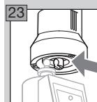
Odpojit magnetický pohon od zásobování napětím. Tlumení je zapuštěno.
